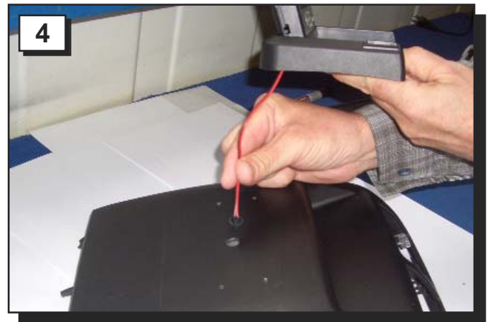
4 Kabel durch die Bohrung führen und das Gerät befestigen, Schrauben nur leicht anziehen, die Verkabelung wie unten gezeigt herstellen
